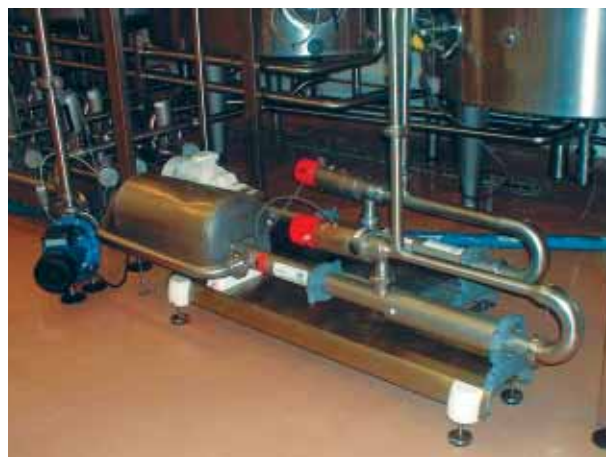
13H12 equipada con un by-pass para la limpieza in situ en el sector de los productos lácteos para la dosificación de nata.
