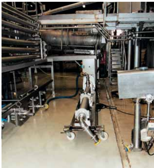
40H24 en el sector de la transformación de frutas y verduras para alimentar con puré un cambiador / refrigerador.
