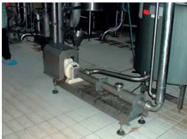
13H6 en la industria láctea para trasvasar leche concentrada a un evaporador.
